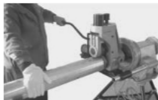
Рис.7 Нажим на трубу, когда силовой привод работает в режиме REV
